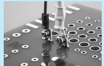
圧着端子取付例 (90°)
