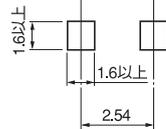
※ランドの端は PC 板の端より 0.7mm 以下として下さい。
