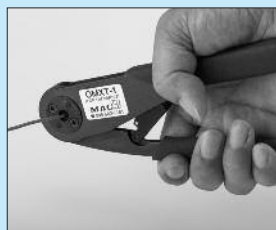
①端子を圧着工具に入れ端子の穴の中に電線を入れる
