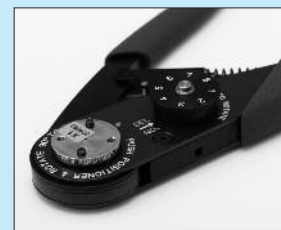
②圧着工具で締めつける。電線の太さによりダイヤル(1~8)を調整する
